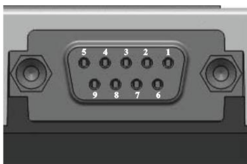
Рисунок 6: Выводы RS-232 (D-Sub 9-контактный)
